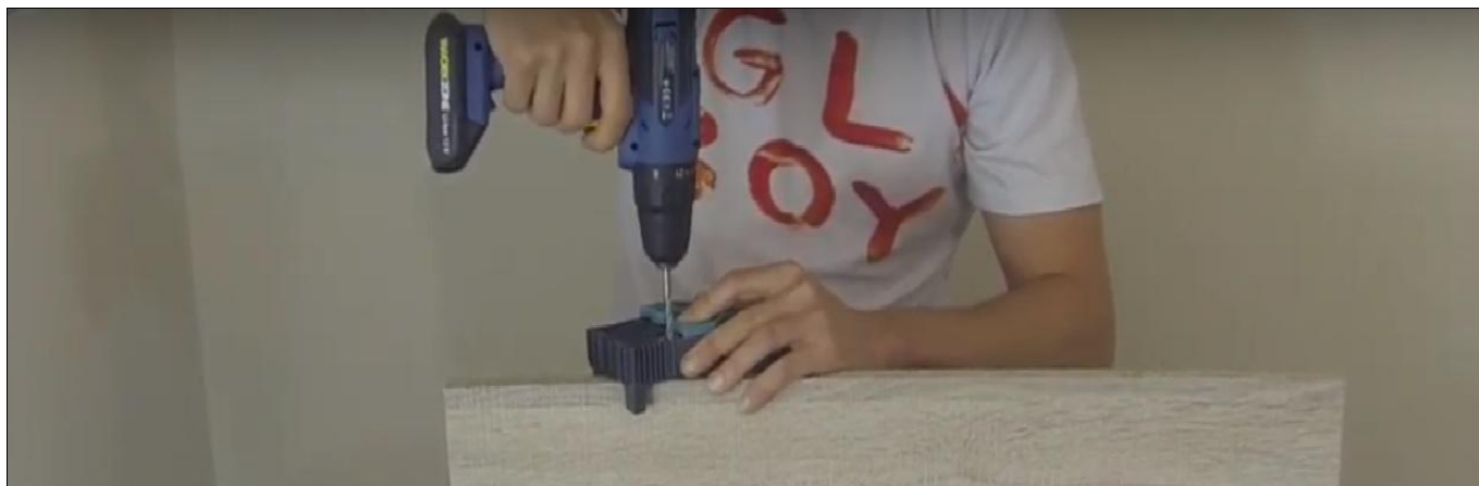
Vrtanie pomocnou kolíkovacieho prípravku na bočné diely.
