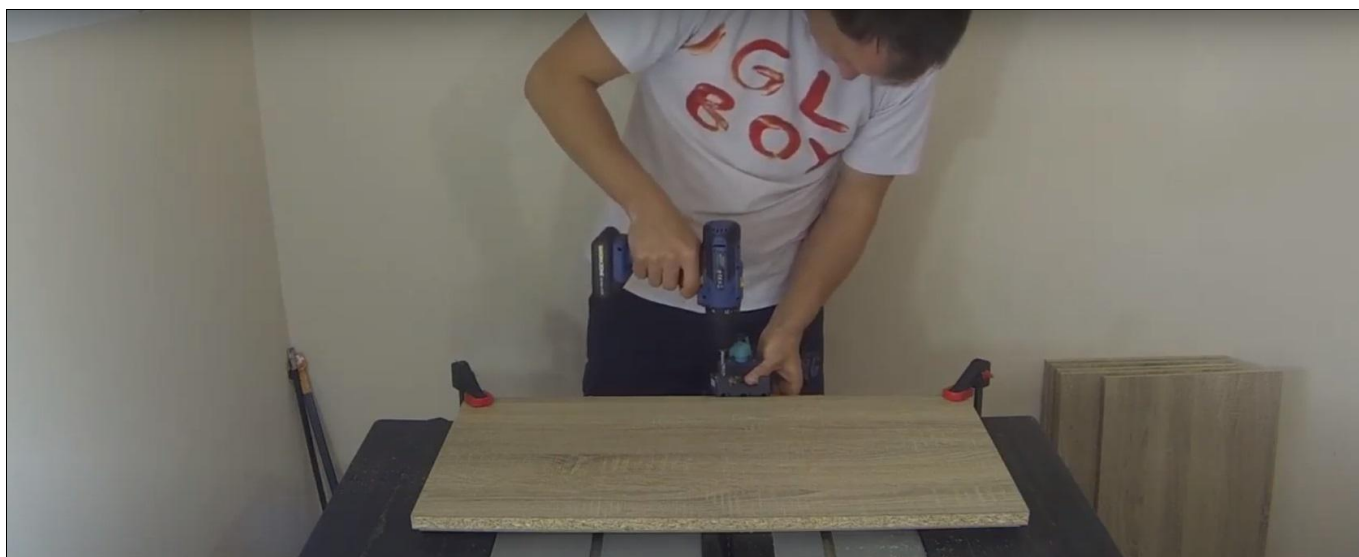
Vrtanie pomocnou kolíkovacieho prípravku na zadnú stenu.
